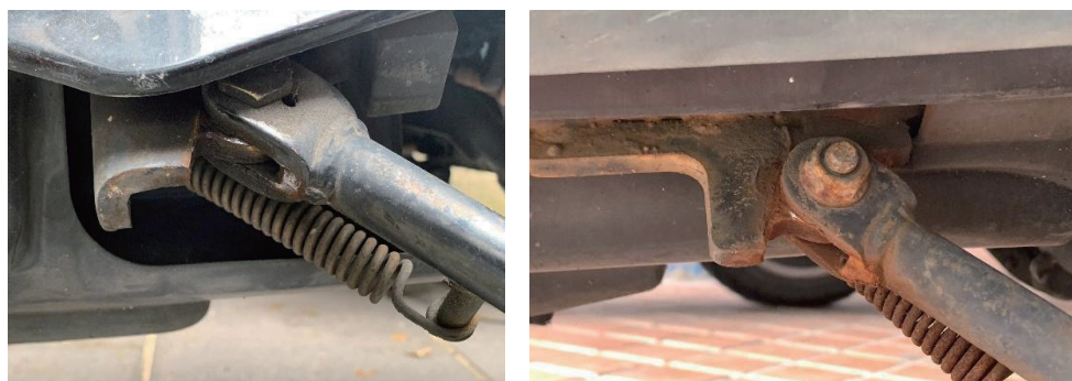
圖 3-11 機車駐車腳架未定期清潔與潤滑，造成使用時收回及定位困難
