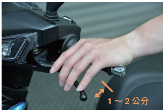
圖 2-1 煞車拉桿放鬆時
