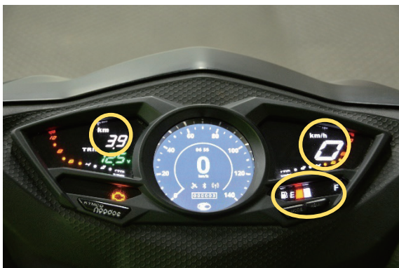
圖 2-5 顯示汽油量、里程及時速
