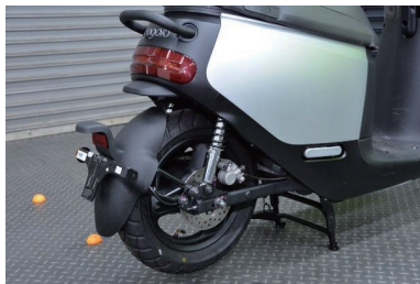
圖 1-3 電動機車無排氣管
