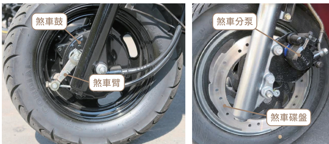
圖 3-8 機車前輪煞車機構，鼓式煞車（左圖）及碟式煞車（右圖）
