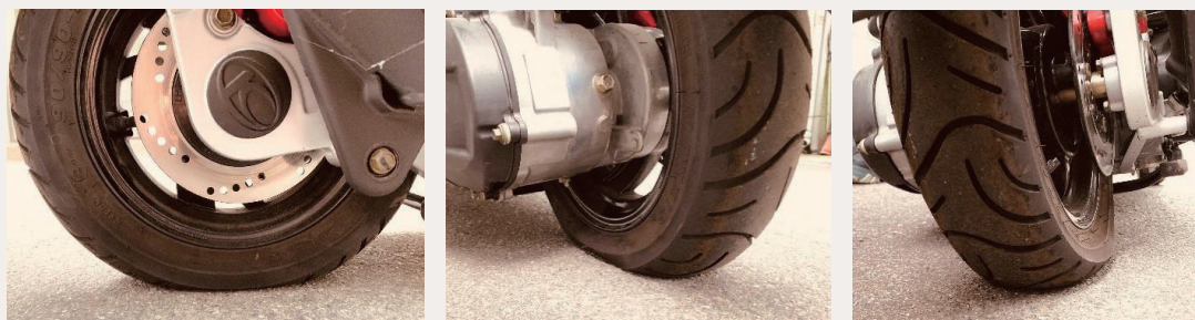
圖 3-18 胎壓過低時機車荷重（左圖）及轉彎時兩側變形嚴重（中間及右圖）
