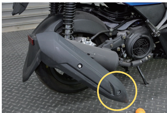
圖 2-23 機車防燙蓋掉落
