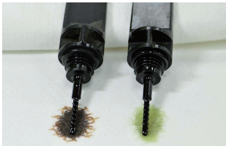
圖 3-2 引擎機油使用超過保養間週期（左）與更換新機油（右）的差異
