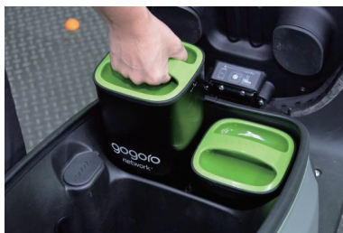
圖 1-4 電動機車使用換電方式
