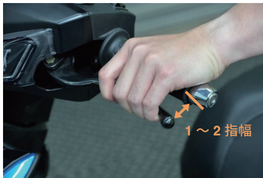
圖 2-2 煞車拉桿拉緊時
