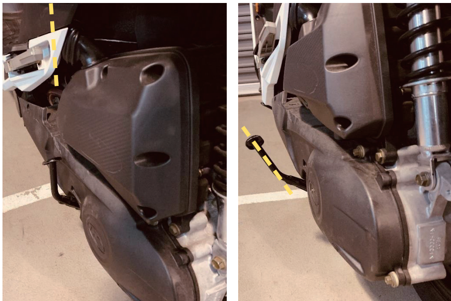
圖 3-13 機車駐車主腳架正常收起（左圖）與變形外翻情形（右圖）
