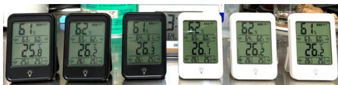
圖 1. 原購得之 6 個溫度計除最左外溫差在 0.2°C 內
