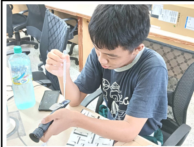
利用鹽度計來測量食鹽水濃度
