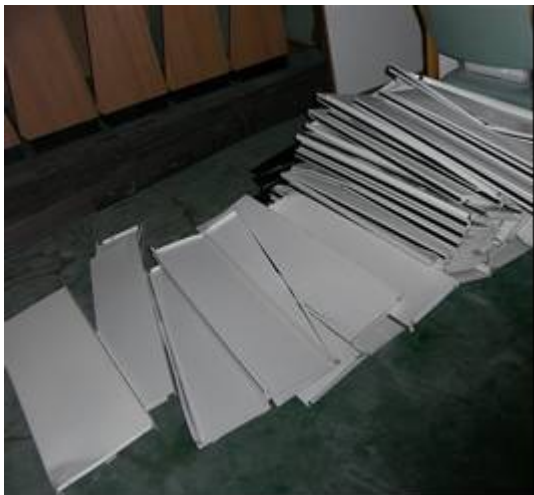
圖 7.6 掉落扭曲變形之書架隔板
